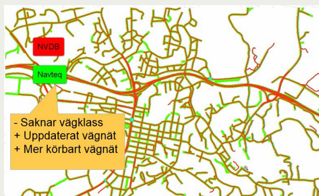
Figur 4. Skillnader mellan databaser NVDB jämfört mot Navteq/HERE.
